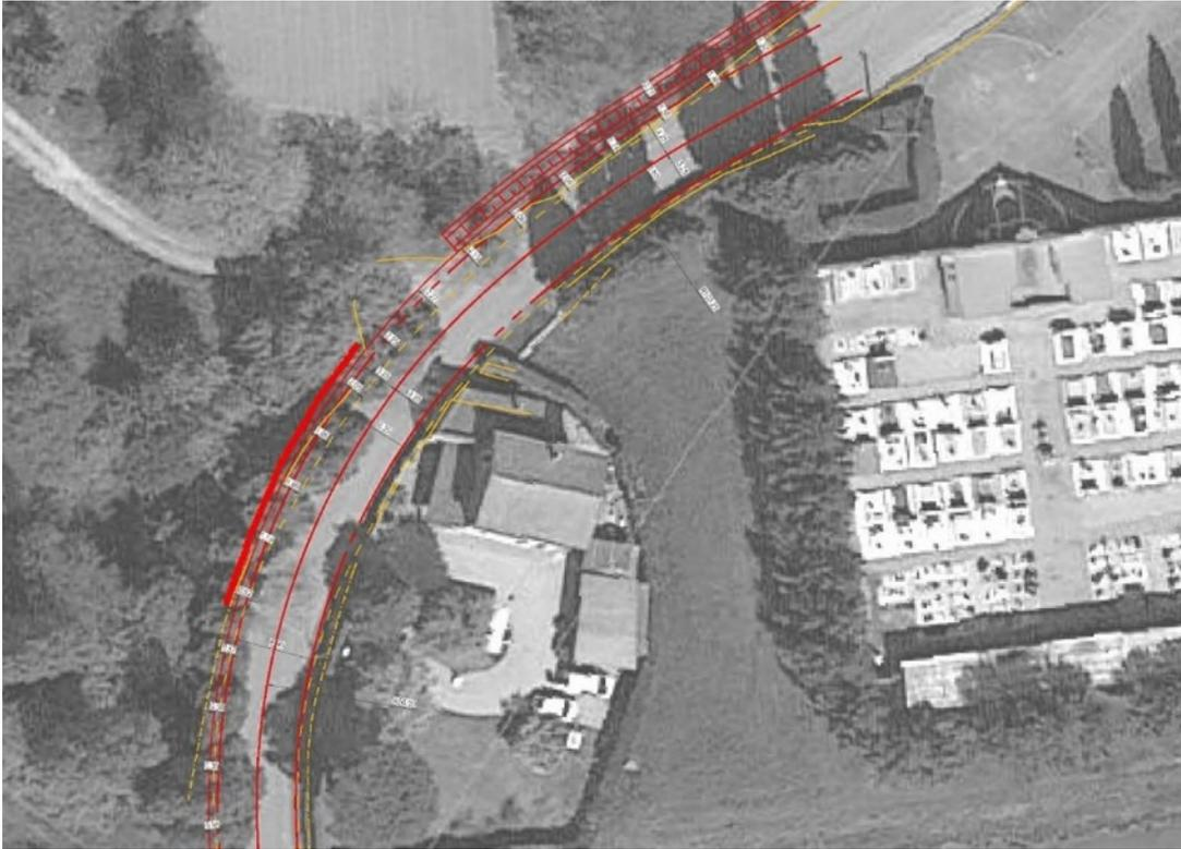
**Figura 6** - Dettaglio della zona di allargamento a nord. (Fonte: progetto di FTE)
