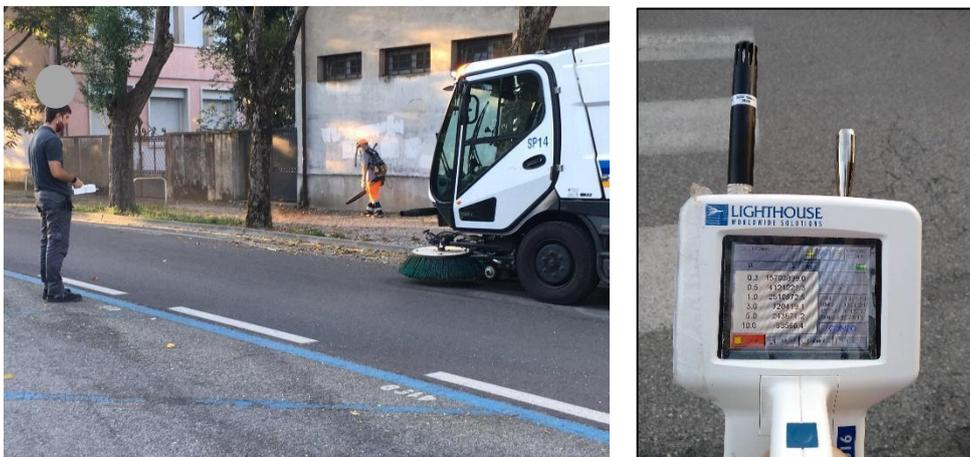
**Figura 9** – Campionamento del particolato ri-sospeso determinato tramite contatore di particelle (a sinistra) e immagine del contatore di particelle (a destra).
